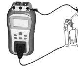
Prüfschaltungen für die Schutzleiterwiderstand-Durchgangswiderstandsmessung
