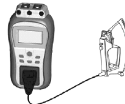
Prüfschaltungen für die Messung des Isolationswiderstands
