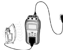
Prüfschaltung für die Differenzstrom-Messung
