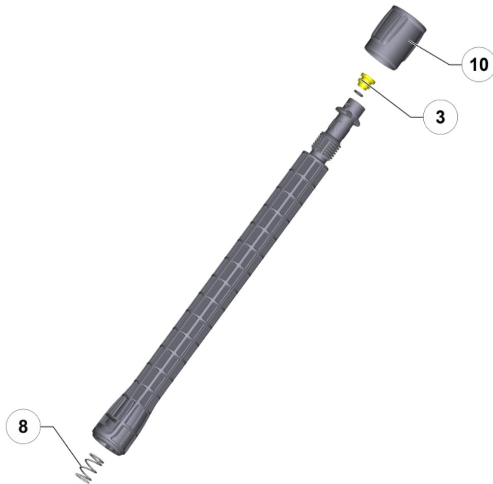
**1 1-СТУПЕНЧАТАЯ УДЛИНИТЕЛЬНАЯ ТРУБКА 0,4 М (2.643-240.0)**
